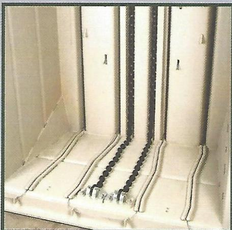
Robuster, hydraulischer Ketten-Ballenauswerfer
