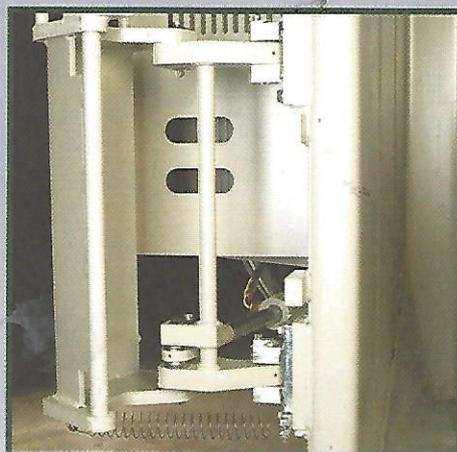
Optional mit hydraulischem Türverschluss
