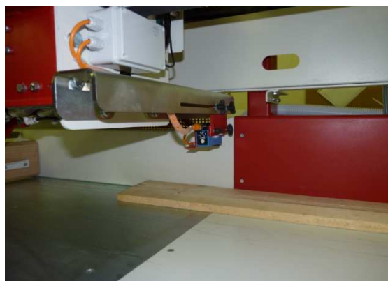
Chybně založen materiál:
