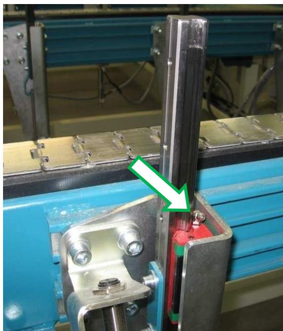
Mazací přípoje na zarážce materiálu
