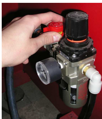
Otevření centrálního tlakového uzávěru stroje
