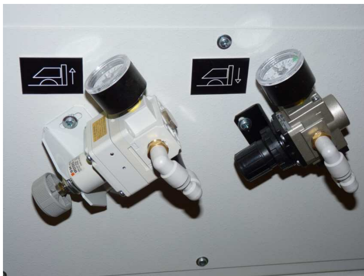
Regulace tlaku horního přítlaku
