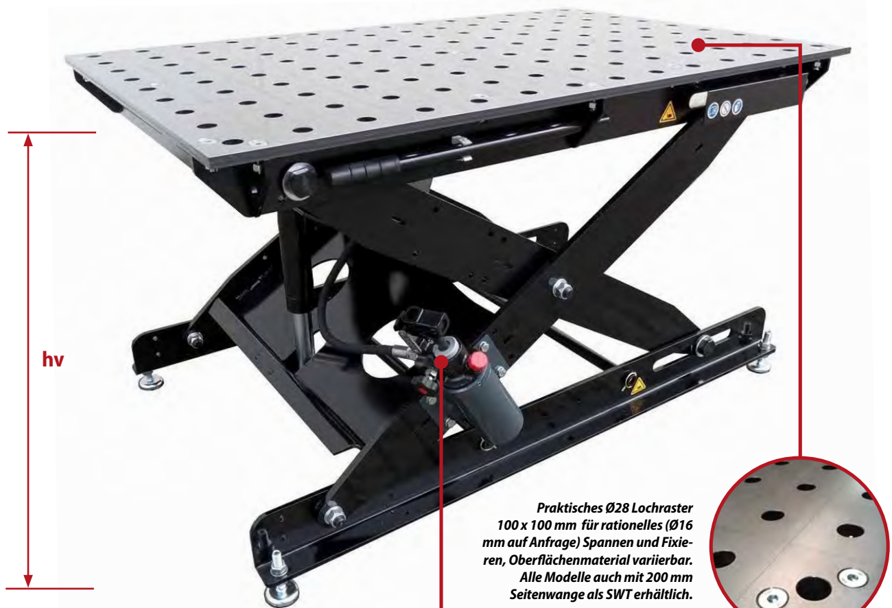
S Abb.: KK kletzer SST 65-105/16 S mit hydraulischer Höhenverstellung von 650 bis 1.050 mm Höhe, Plattenmaße 1.400 x 900 mm, in Standardfarbe Schwarz
