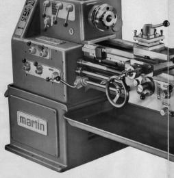
Formschöne, stabile Konstruktion Breite Bettführungsbahnen Spindelkopf mit Bajonettscheibenverschluß Elektromagnetische Bremse
