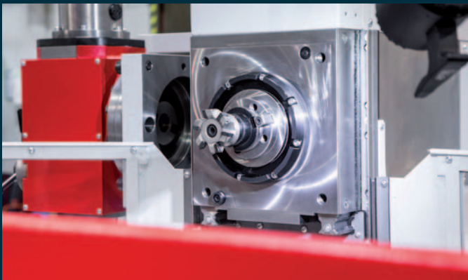
Wechsel auf Horizontalfräsen. Horizontale Frässpindel DIN69871 SK40
