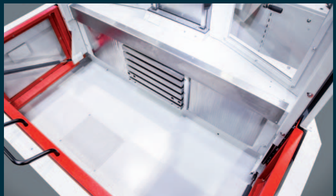
Versenkbarer Arbeitsschutz mit senkrechter Aufspannfläche.
