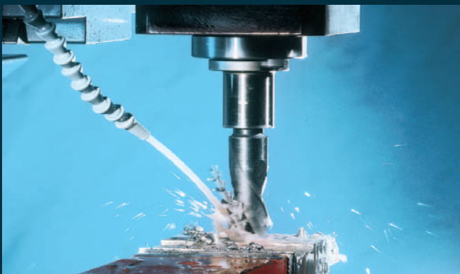
Vertikalfräskopf. Bohren von großen Durchmessern mit Vertikalfräskopf. Pinolenhub bis 80 mm
