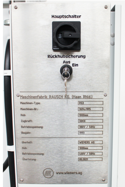
Hauptschalter mit Schlüsselschalter für Rückhubsicherung
