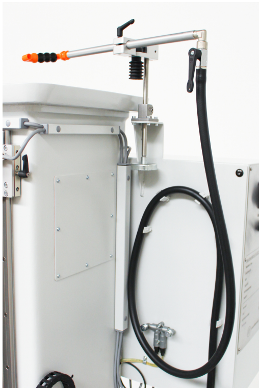
Außenliegende Zentralschmierpunkte für den Trapezspindeltrieb
