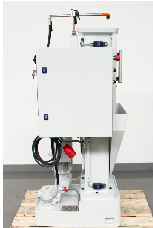
Ansicht Maschinenseite links mit Schaltschrank & Kühlmittleinrichtung
