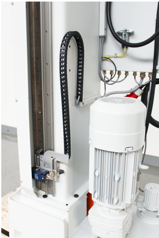
Außenliegende Räumhubverstellung und Hauptantriebsmotor
