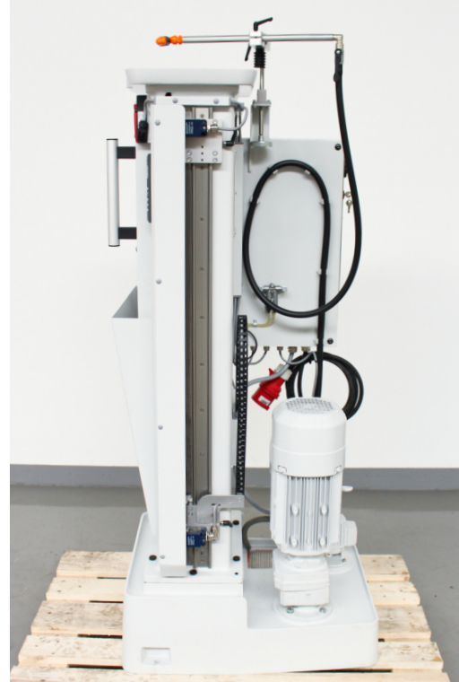
Ansicht Maschinenseite rechts mit außenliegender Verstellung des Räumhubes
