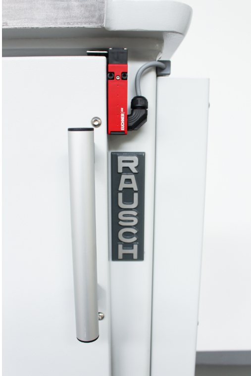
Schutztür mit Sicherheitsabfrage
