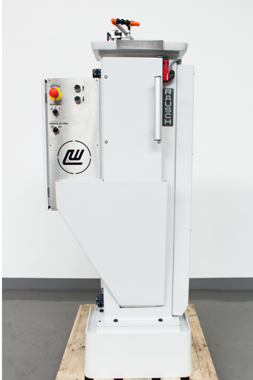
Vorderansicht der Maschine mit Bedienpanel, Spänefang und Schutztür
