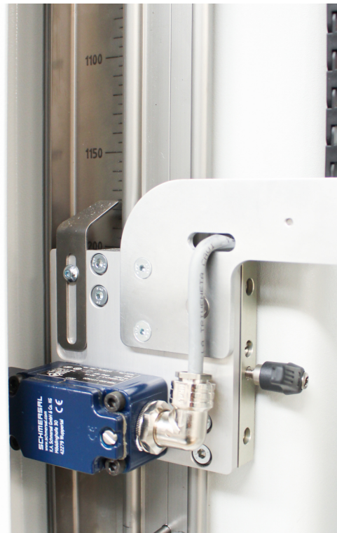
Detailansicht der Räumhubverstellung mit maschinenübergreifender Reproduzierbarkeit
