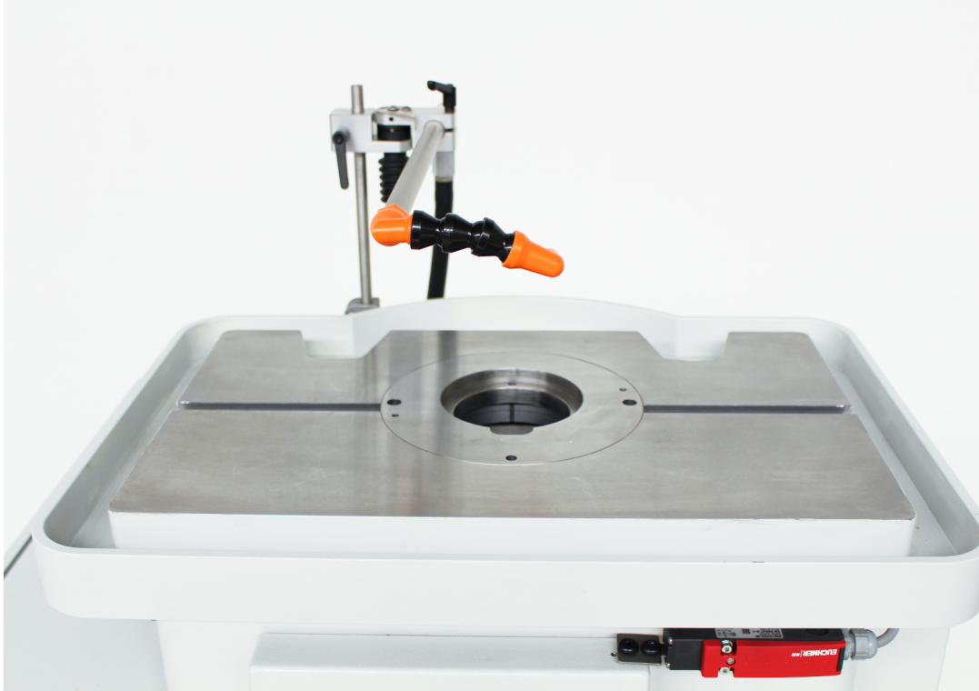
Schmiermittel-Schwenksystem in zentraler, wiederholgenauer Rastposition
