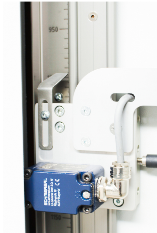
Detailansicht der Räumhubverstellung mit maschinenübergreifender Reproduzierbarkeit
