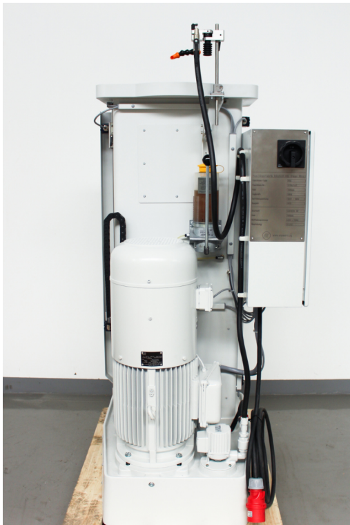
Ansicht Maschinenrückseite mit Hauptantrieb
