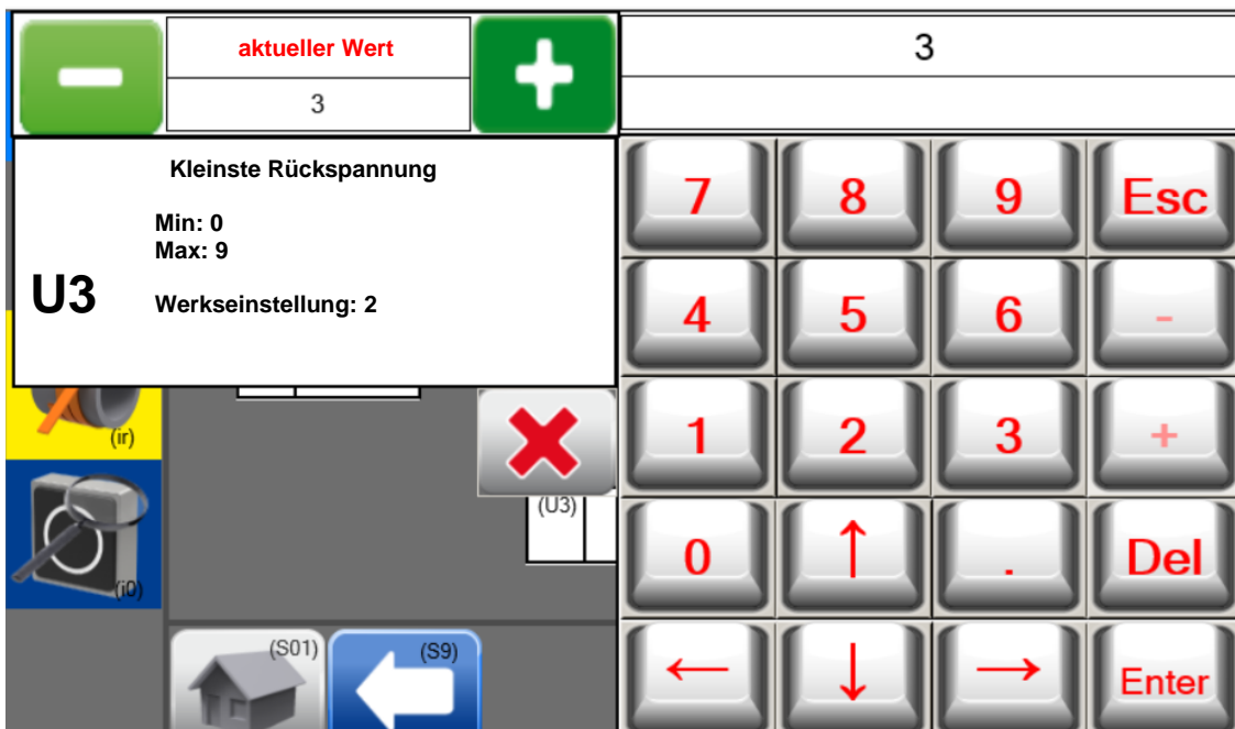
Abbildung 41: kleinster Rückspannwert U3
