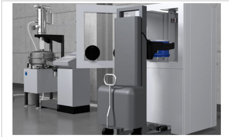
Pulverkreislauf: Entpackstation beladen
