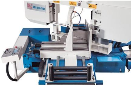
*Manuelle Winkelverstellung des Sägebügels mit hydraulischem Antrieb ( 15°, 30° und 45°)*
