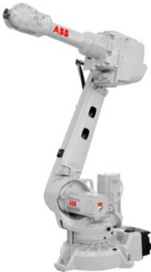
Der kompakte Roboter IRB 2600 hat eine hohe Traglast und ist in drei Versionen verfügbar. Sein Design wurde speziell für die Anwendungsbereiche Lichtbogenschweißen, Materialhandhabung und Maschinenbedienung optimiert.
