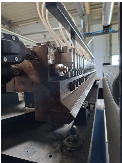
Abb. 2 – Seitenansicht des Auftragskopfbalkens mit Einzelköpfen und Druckluftleitungen
