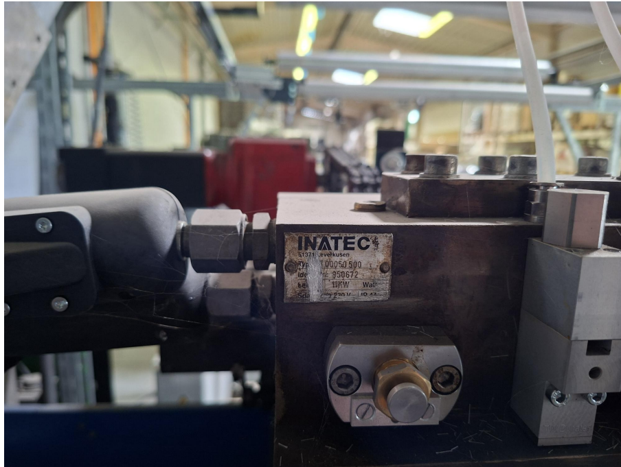
Abb. 1 – Typenschild INATEC: Typ 100050 500, Ident.-Nr. 950672, 11 kW, 230 V, IP 44, Leverkusen
