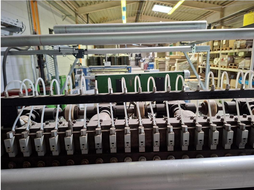
Abb. 4 – Gesamtansicht des Balkens von oben: Auftragskopfreihe mit Druckluftschlaufen und grünem Steuermodul
