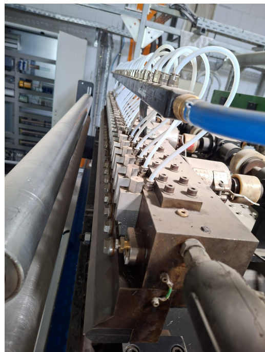
Abb. 3 – Schrägansicht: Anschlussseite mit Heizmasse-Block und Druckluftzuführung
