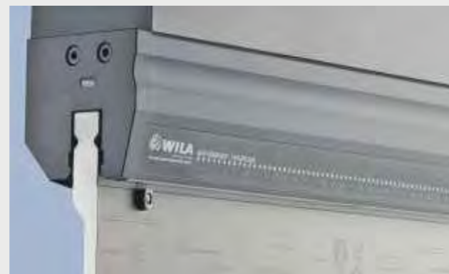
Wila NSCL-I-HC/UPB Wila hydraulische obere Werkzeugklemmung
