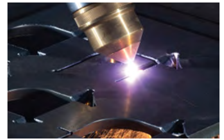
CNC Plasma- und Brennschneidanlagen für eine breite Palette von Baustahl, Edelstahl und Aluminium
