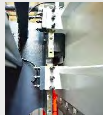
Doppelte Linearführung für höhere Präzision und Stabilität
