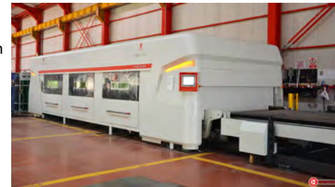
Faser-Laser-Schneidanlagen Strahlenübertragung über flexiblen Lichtwellenleiter
