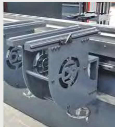
Auflagearm schwere Ausführung >175 to Presskraft
