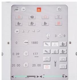
*Hochauflösender Touchscreen mit kratzfester der Oberfläche. Zum Bohrer passende Drehzahlen und Vorschubgeschwindigkeiten können einer Datenbank abgerufen und automatisch übernommen werden.*
