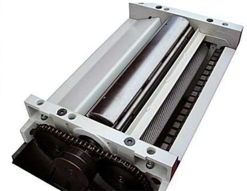
massiver Graugusslagerbock, schrägverzahnte Stahleinzugwalze, massive Rückschlagsicherung
