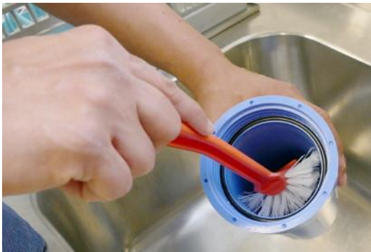
3. Filtergehäuse gründlich reinigen und ausspülen. Ablagerungen entfernen.
