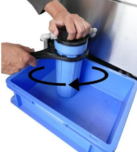
1. Das Gehäuse mit dem Schlüssel im Uhrzeigersinn aufdrehen. Auffangwanne unterstellen!
