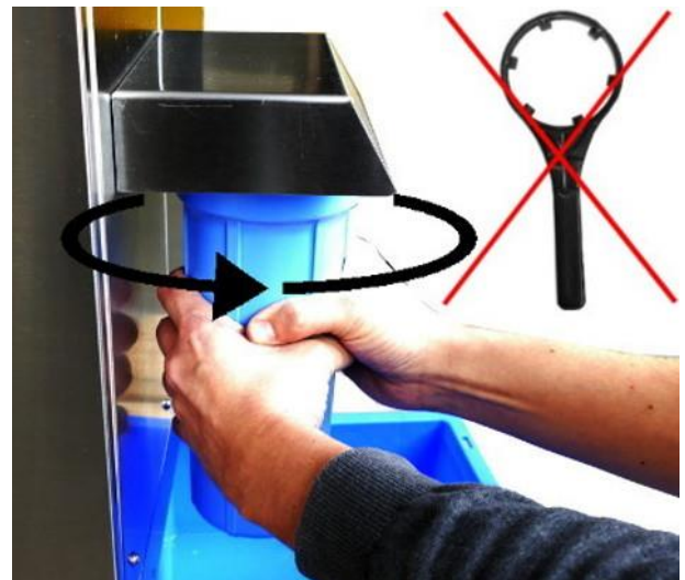
6. Gehäuse senkrecht halten und von Hand festschrauben.
