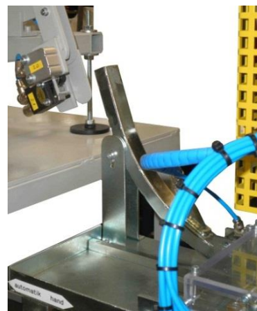
Übergabe der Alu-Halter an das Schraubgerät
