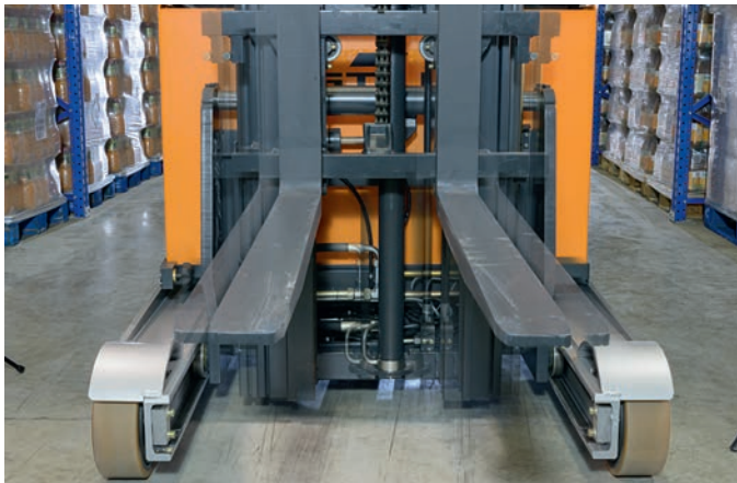
Der einzigartige Mastquerverschub sowie die außermittige Platzierung des Hubzylinders sorgen für ungehinderte Sicht auf die Ware
