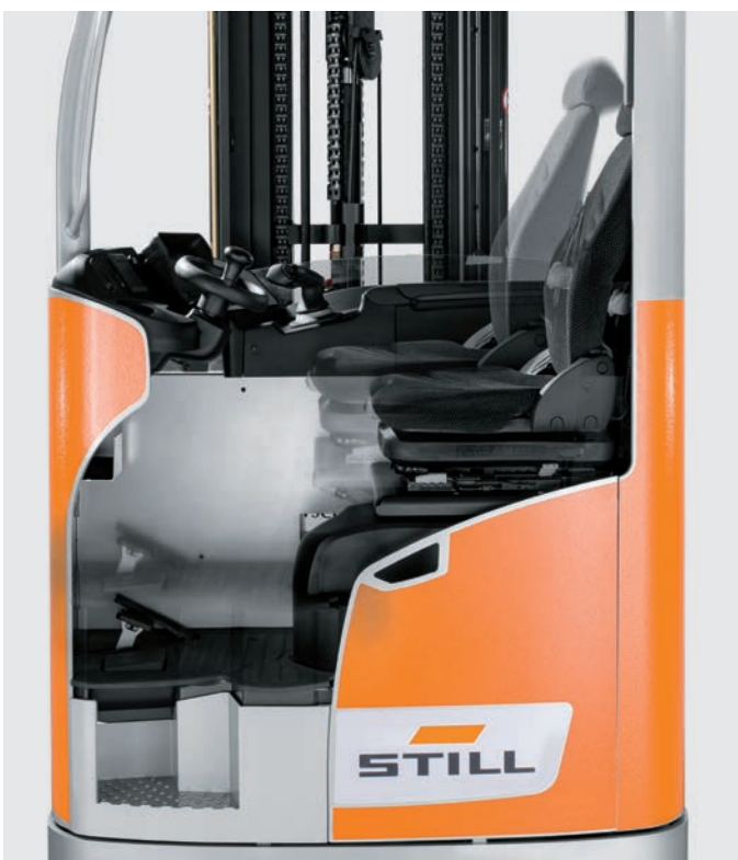
Individuelle Einstellungen des Fahrerarbeitsplatzes, wie die proportionale Sitz- und Fußplattenkonfiguration, sichern Ergonomie und Komfort
