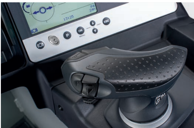
Ergonomische, präzise und ermüdungsfreie Bedienung und Steuerung mit dem innovativen Joystick 4Plus
