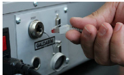
PC-Anbindung über EtherCat Hochgeschwindigkeits-Kommunikation
