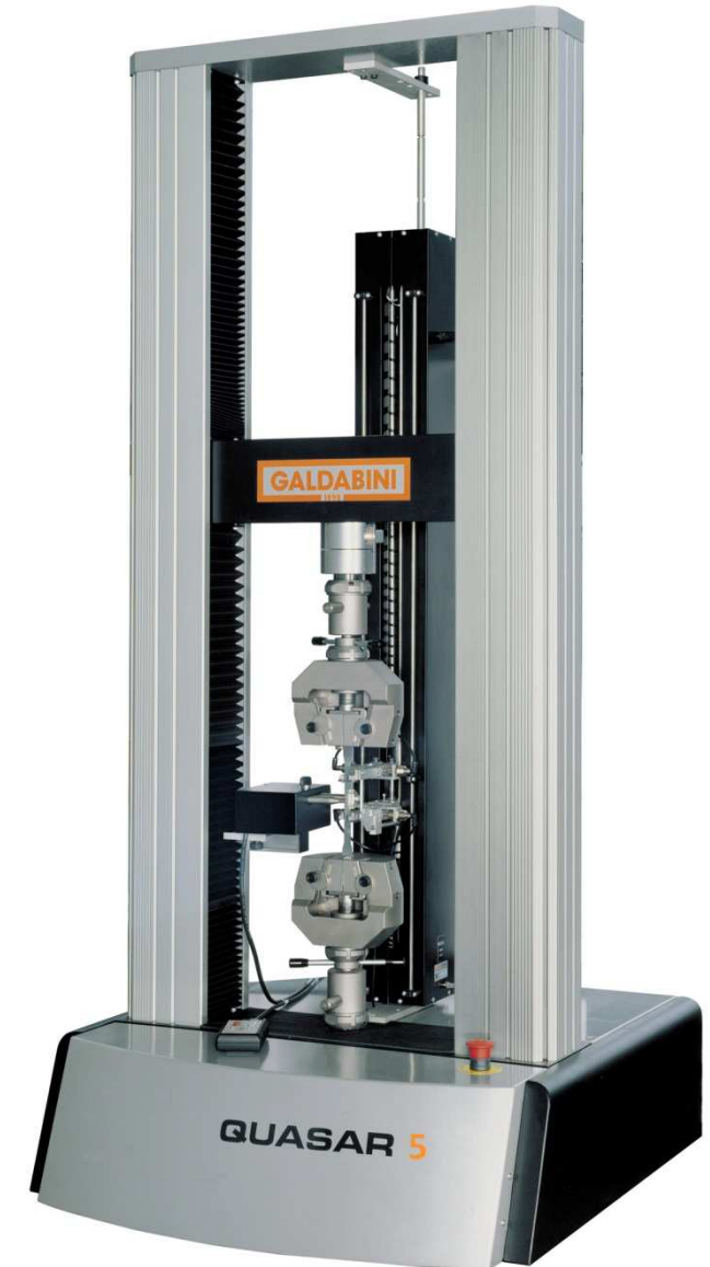
QUASAR 5 kN Optionen: manuelles Keilschraubspannzeug, Extensometer MICRON
