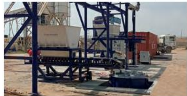
Nijerya - ZIM T 1015 Beton Baca Üretim Tesisi Nigeria - ZIM T 1015 Concrete Manhole Production Facility
