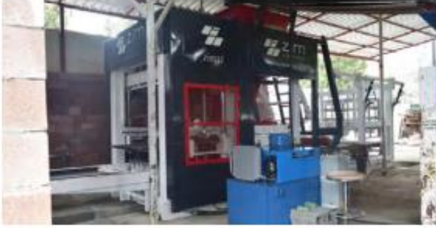
Türkiye - ZIM 121 Tipi Beton Parke ve Blok Üretim Tesisi Turkey - ZIM 121 Type Concrete Pavers and Block Production Facility
