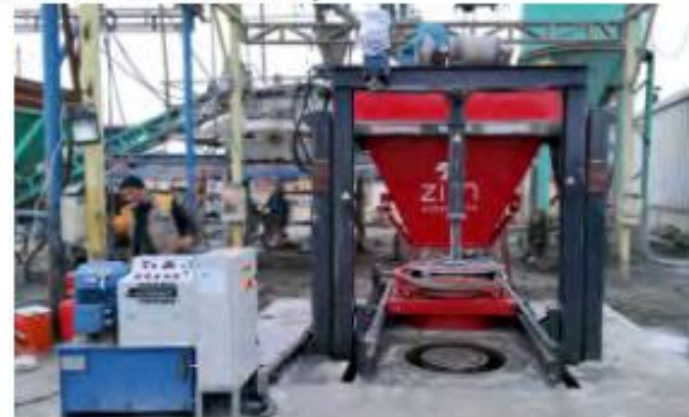
Türkiye - ZIM T 815 Beton Boru Üretim Tesisi Turkey - ZIM T 815 Concrete Pipe Production Facility
