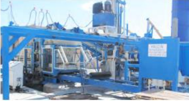
Cezayir - ZIM 1025 L Tipi Beton Parke ve Blok Üretim Tesisi Algeria - ZIM 1025 L Type Concrete Pavers and Block Production Facility
