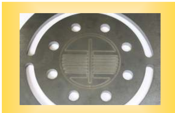
Schneidprobe mit Markierung (PerCut 370.1M)
