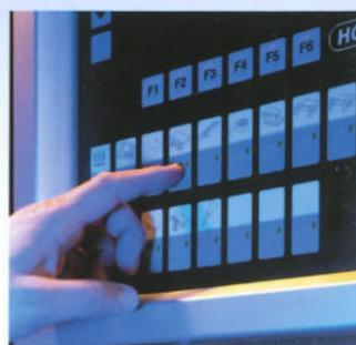
Die SPS-Maschinensteuerung ist die Schaltzentrale der TRIATHLON. Integrierte Streckensteuerung und Betriebsdatenerfassung, Programmnamen und Bedianhinweise in Klartext, automatisches Einrichten sind nur einige der Leistungsmerkmale. Ein Plus an Komfort und Leistung bietet die optionale PC-Steuerung. Hier reicht das Spektrum bis zur Offline-Programmerstellung, Netzwerk-anbindung und Fernwartung
