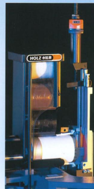
Flexibilität bis hin zum Eckkopieren. Das patentierte Kopierfräsaggregat 1983 AW ermöglicht den automatischen Wechsel zwischen drei verschiedenen Profilformen.
