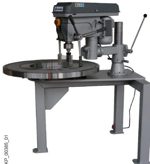
Fig. 58: Countersinking a die
