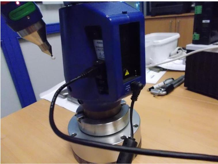
1. Faro Arm mit Netzteil und USB-Kabel mit dem Laptop verbinden
