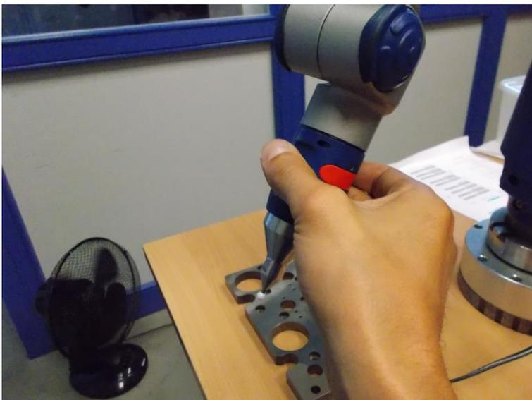
6. Mit der Innensechskantschraube am Boden des Armes Den Arm auf einer Stahlplatte fixieren (Funktion wie Magnetuhr)
