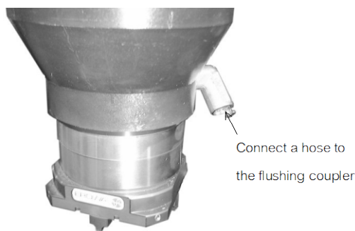
Obr 5-7 Rozhraní pro připojení hadice průchozího vyplachování
