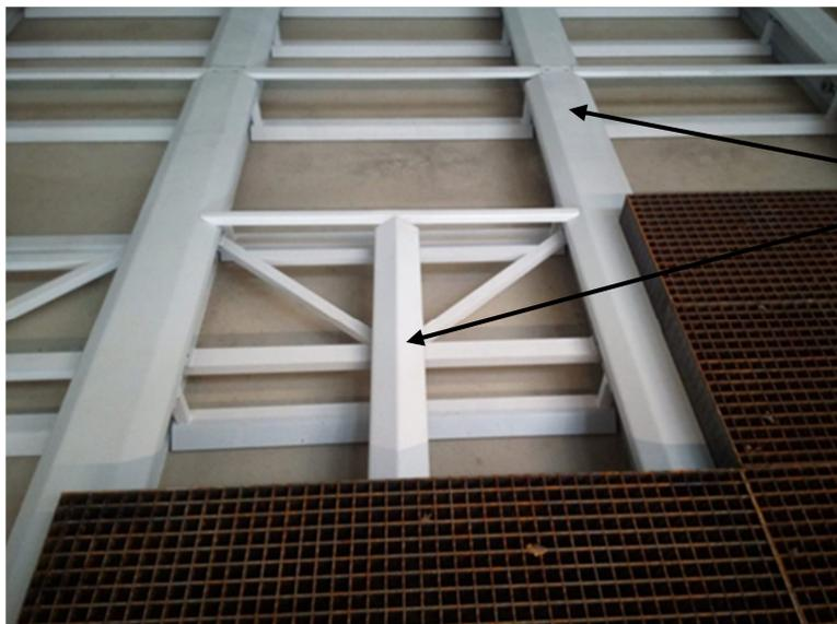
Abdeckhauben für das Schubsystem zum Schutz der Lager und der Zahnstangen
