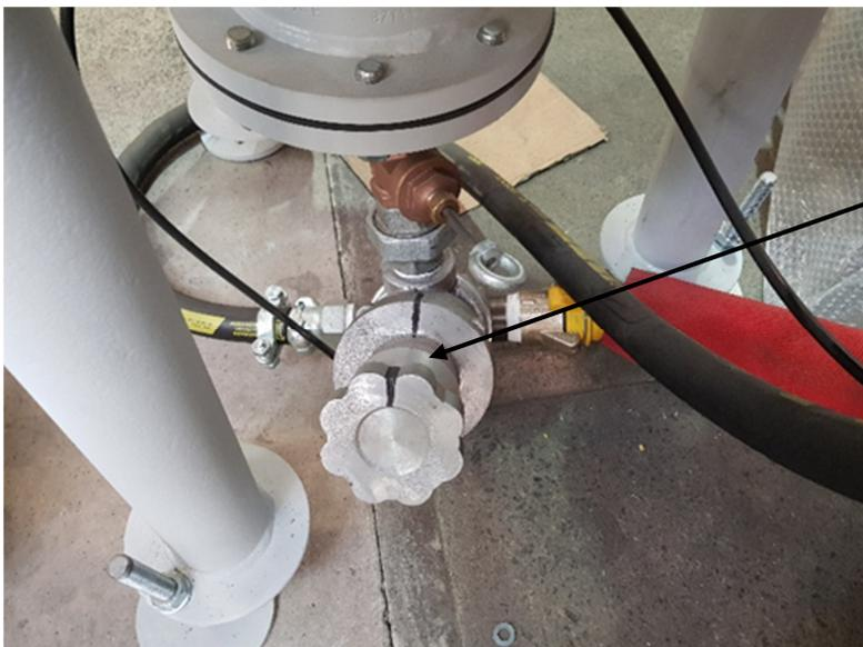
Strahlmitteldosierventil pneumatisch gesteuert.
