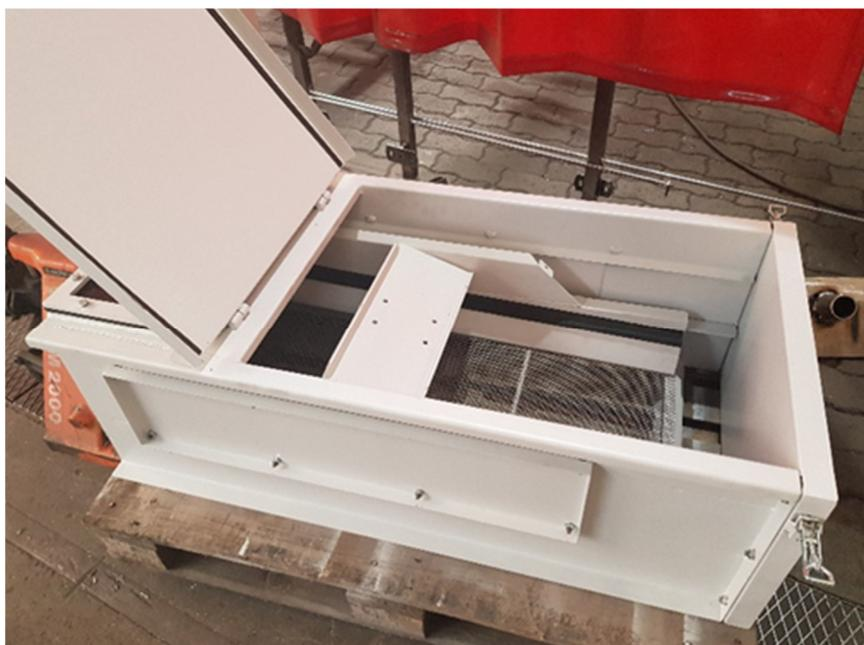
Automatische Strahlmittelnachfüllung. Die automatische Nachfüllung hat den Vorteil dass der Schließkegel vom Druckstrahlkessel nach dem Befüllen nicht mit Strahlmittel belegt ist. Bei Schließkegel die mit Strahlmittel belegt sind kommt es vor, dass diese nicht immer richtig schließen. Hierbei entstehen Verwirbelungen die den Kegel und den Dichtflansch beschädigen. Des weiteren fängt das Strahlmittel beim Strahlen durch die Falschlucht an zu pulsieren.
