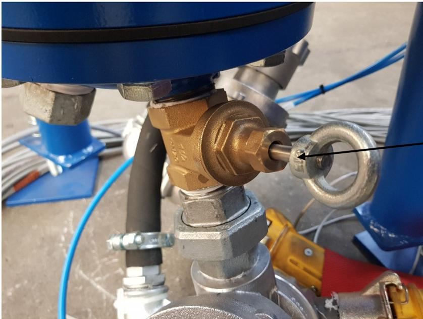
Sperrschieber für Strahlmittel im Druckkessel
