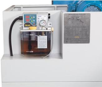
*Eine Zentralschmierung versorgt alle Schmierstellen einer Maschine automatisch und kontinuierlich mit dem erforderlichen Schmierstoff. Ein zentraler Behälter speichert den Schmierstoff, der über ein Leitungssystem zu den einzelnen Schmierstellen verteilt wird. Die Dosierung erfolgt elektronisch geregelt*
