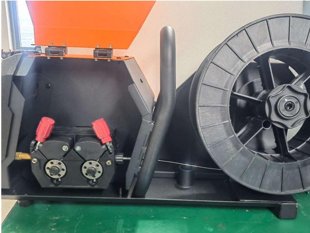
Abbildung 4-2 Innenleben des Drahtvorschubs
