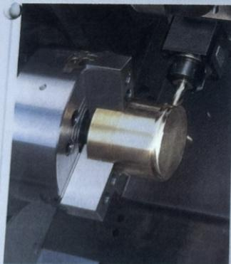
Während der Rotation der Spindel ist das Fräsen möglich. Für die Hochpräzisions-Konturenkontrolle wird durch einen DDS\*-Motor gesorgt, der als Servomechanismus für das Indizieren der C-Achse fungiert.
