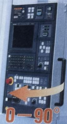
Die Schwenkbare Bedientafel schont die Augen und verbessert die Einsatzfähigkeit.
