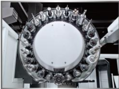
24T Werkzeugmagazin vom Typ Disc
