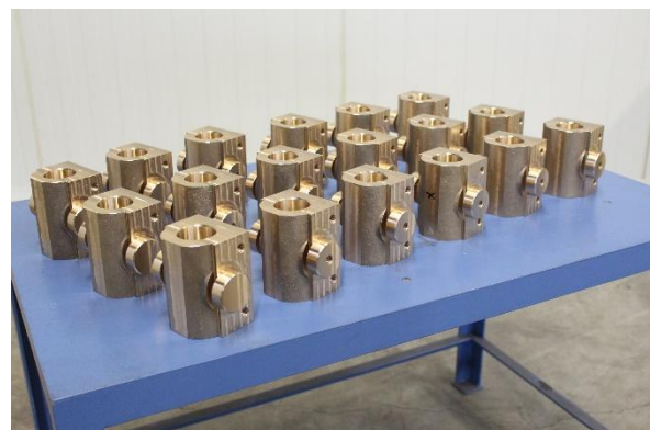
Bild mit fertig bearbeiteter Außenkontur der Spindelmuttern für die Baugröße RS 3 ohne das Trapezgewinde (wird auf die Mutter angepasst)
