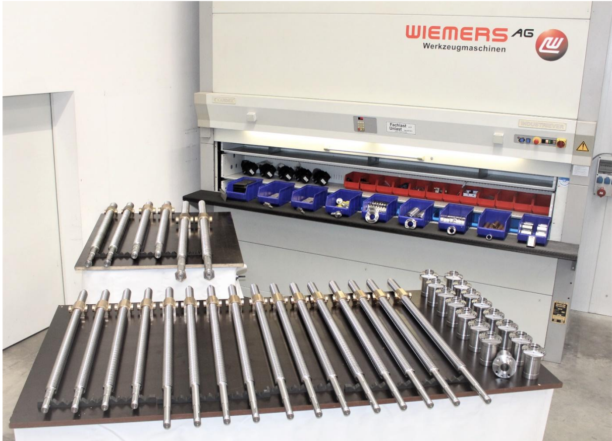
Lagerpaternoster mit diversen Ersatzteilen und neuen Antriebsspindel für die verschiedenen Maschinenvarianten und Leistungsgrößen
