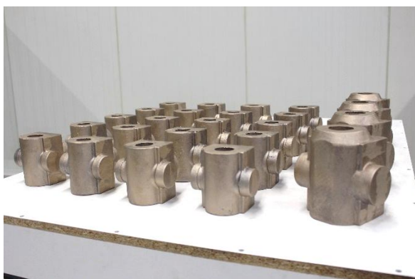
Bild mit diversen gegossenen Spindelmuttern für die Maschinen der Baureihe RS 3 und RS 6
