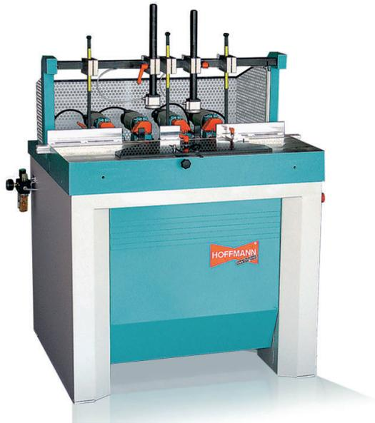
Standversion mit stabilem Gusstisch und großer Arbeitsfläche in bequemer Arbeitshöhe. Mit vier Fräsgruppen, fräst pro Arbeitstakt in zwei Werkstücke je zwei Keilnuten für die Schwalbengrößen W-1/-2/-3. Stufenlos einstellbarer Spindelabstand von 32 bis 100 mm. Bei der Bearbeitung von Kranzrahmen können inneres und äußeres Fräserpaar auf unterschiedliche Frästiefen eingestellt werden.
