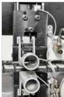
RC-N Flachziehklinge Nestingfähiges Reinigen des überschüssigen Leimes auf der Werkstückoberfläche.
