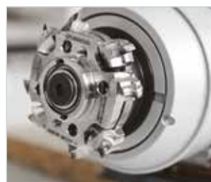
Round 2-A Eckenkopieren 2 Motoren für 2 Radien, mit automatischem Wechsel der entsprechenden Fräser.
