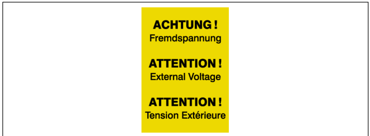
Abb. 6: Piktogramm „Fremdspannung“ innerhalb des Gehäuses des Umrichters
