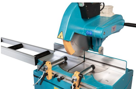
Der Sägekopf kann beidseitig auf bis zu zu 45° geschwenkt werden
