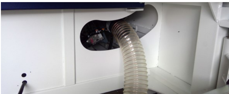
Abb.5-15: Anschluss Absaugschlauch an der Formatkreissäge
