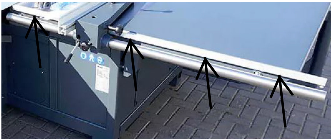
Abb.5-5: Montage Anschlagleiste Parallelanschlag
