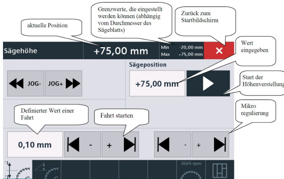
Abb. 6-9: Höhenverstellung Sägeblatt FKS 550-3200 M A 3 UP TOP
