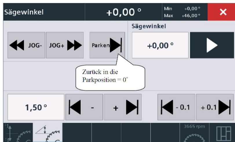
Abb. 6-10: Sägeblattneigung Sägeblatt FKS 550-3200 M A 3 UP TOP
