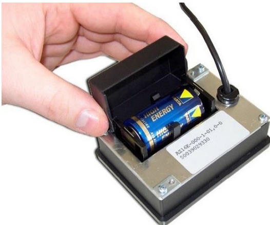
Abb.6-27: Auswechseln der Batterie
