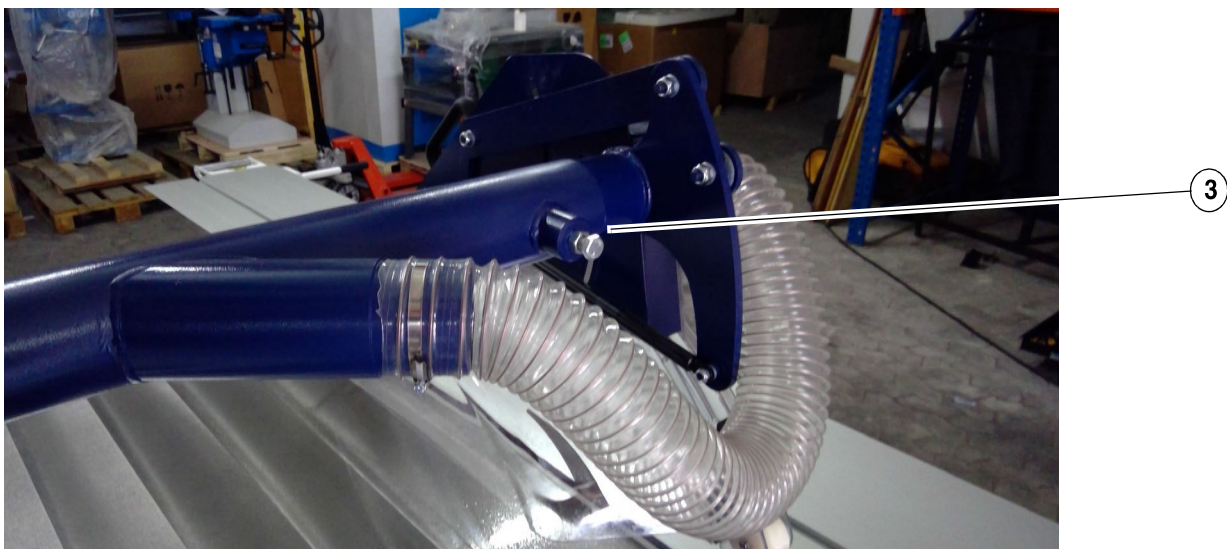
Abb.5-9: Montage Pendelschutzhaube an den Schwenkarm
