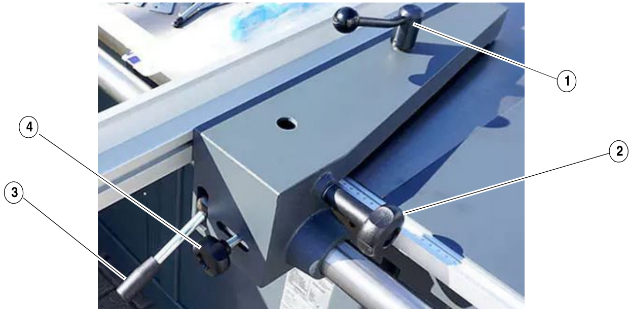
Abb.6-11: Einstellung des Queranschlags FKS 550-2300 PRO
