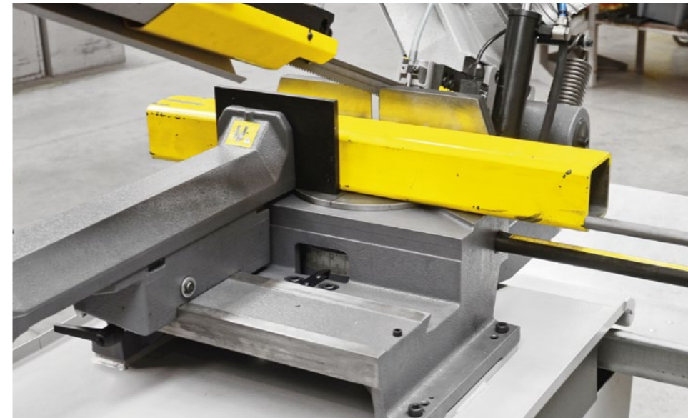
Die Schnellverstellung ermöglicht das Zustellen des Spannstockes innerhalb von Sekunden für den gesamten Spannbereich
