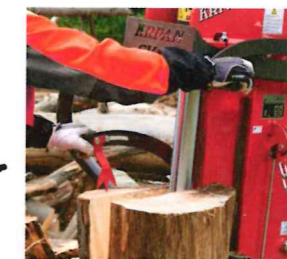
Linke Bedienungshebel mit integrierter Spaltgutfixierung
