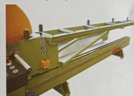
Bewegliche Rollenbahn Moveable roller table
