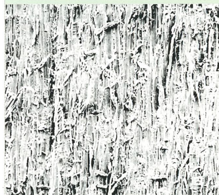
Rasterelektronenmikroskop-Aufnahme: Werkstückoberfläche geschliffen
