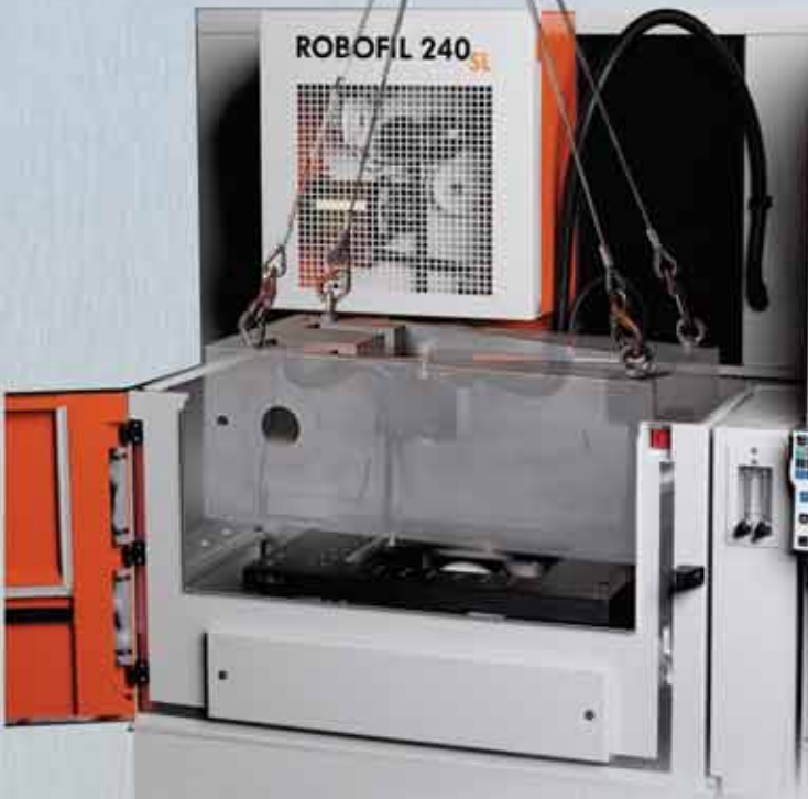
Große UV-Verfahrwege, um Beladung mittels Kran zu erleichtern
