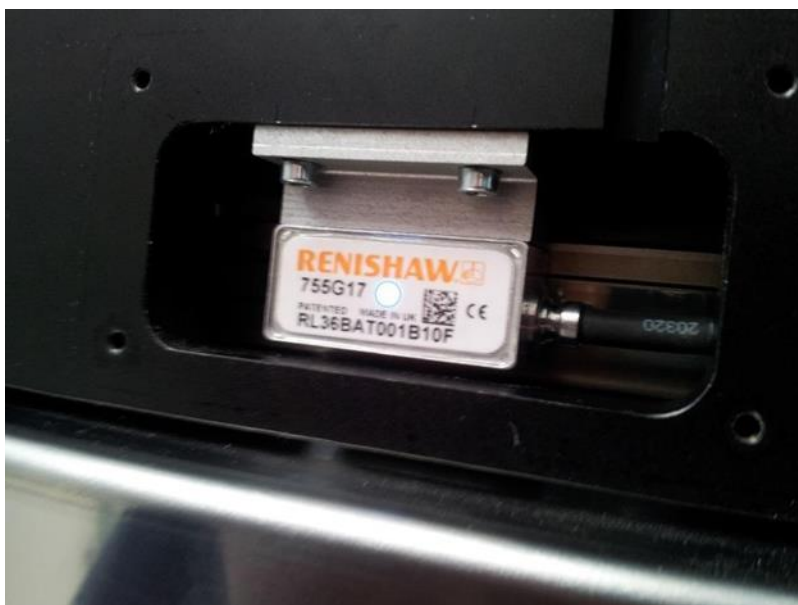
Fotografie 17 Správně instalovaný snímač
