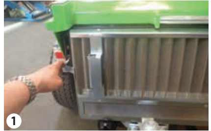
1 Abbau der Wasserkühlerabdeckung
