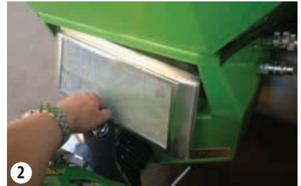
Einbau der Ölkühlerabdeckung
