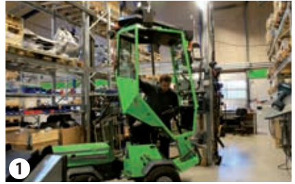
1 Absenken der Fahrerkabine
