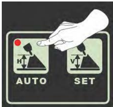
Automatisches Überprüfen des Abstands zwischen Brenner und Werkstück
