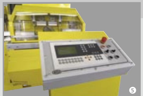
Separates Bedienpult für SPS-Positionierungssteuerung der GAMA 75 V5.
