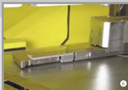
Längenmesswagen – GAMA 75 V5 Endlos – Messsystem über Verfahreneinrichtung in Verbindung mit Vorschubsystem. Messgenauigkeit 0,1 mm Positioniergenauigkeit \pm 1 mm
