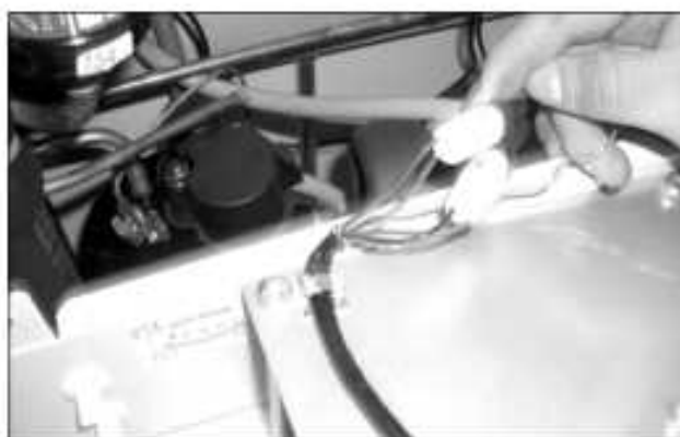
Abb. 70: Steckverbindungen des Lüfters abziehen (2)
