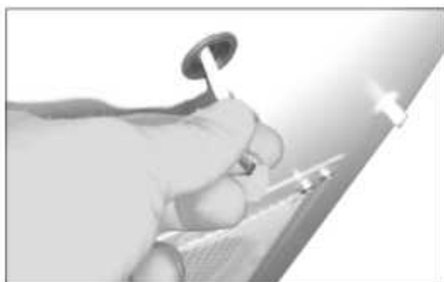
Abb. 65: Displaykabel zurückschieben und durch Kabeldurchführung drücken (1)
