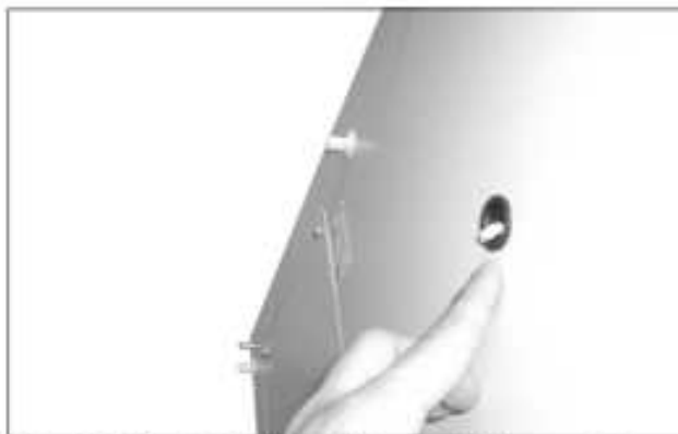
Abb. 50: Displaykabel durch Kabeldurchführung drücken
