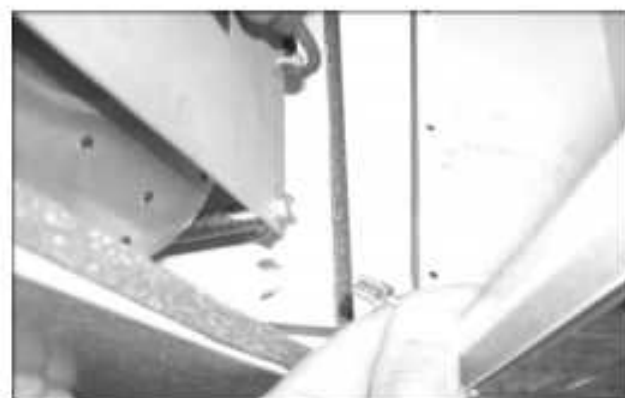
Abb. 54: Erdungskabel zwischen Haube und Chassis lösen (2)
