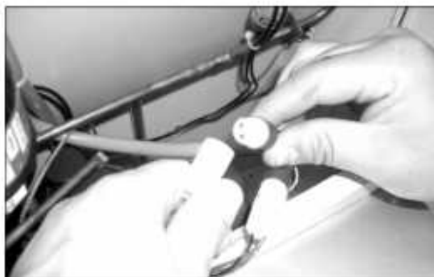
Abb. 71: Steckverbindungen des Lüfters abziehen (3)
