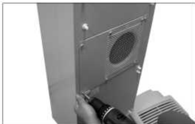
Abb. 67: Vier Schrauben des Außenkreislauf Lüfters lösen
