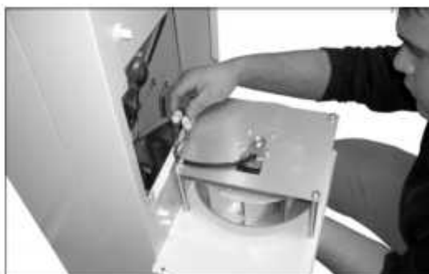
Abb. 69: Steckverbindungen des Lüfters abziehen (1)
