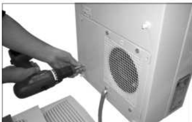
Abb. 45: Außenkreislauf Lüfter ausbauen (vier Schrauben lösen)
