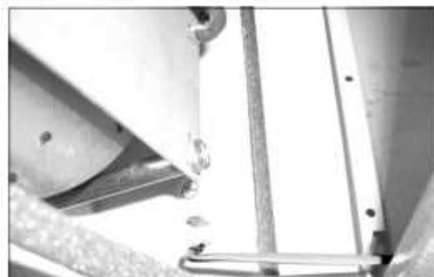
Abb. 53: Erdungskabel zwischen Haube und Chassis lösen (1)
