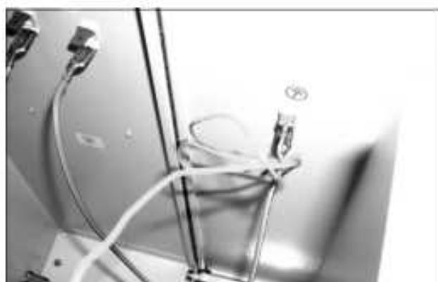
Abb. 72: Erdungskabel des Lüfters abziehen (1)
