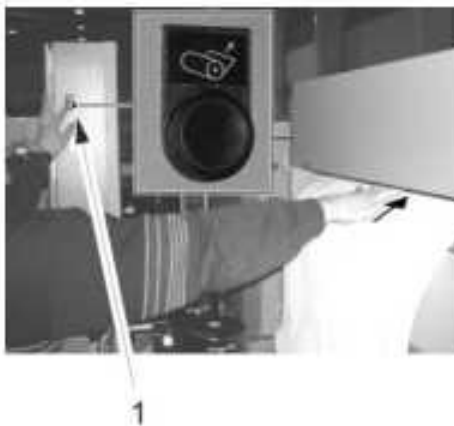
Abb. 89: Filtervlies mit Vorschubtaster einführen
