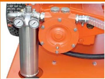
Integrierte Vordruckpumpe mit Vorfilter und Vordrucküberwachung.
