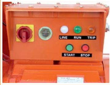
Spritzguß- Schaltkasten mit Hauptschalter/ Schutzschalter & Stundenzähler.
