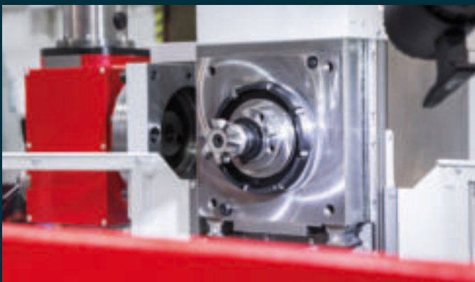
Wechsel auf Horizontalfräsen. Horizontale Frässpindel DIN69871 SK40
