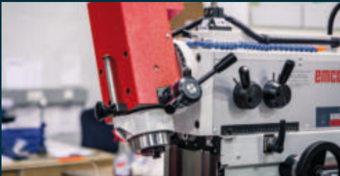
Vertikalfräskopf. Vertikaler Fräskopf mit DIN 2080 SK 30 und klemmbarem 45 mm Pinolenhub. Der Vertikalfräskopf ist um \pm 90^\circ schwenkbar.
