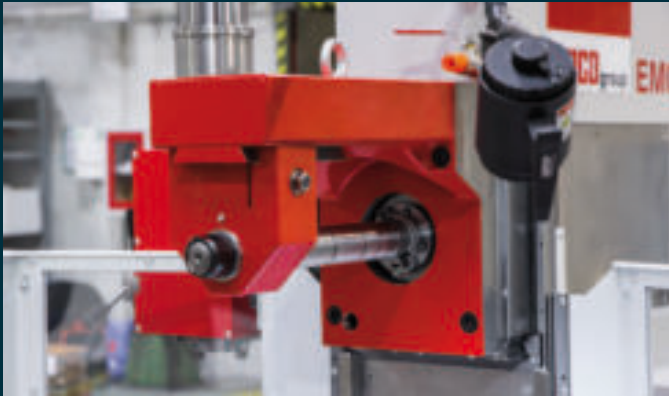
Horizontalfräsen. Horizontalfräsen mit langem Fräsdorn zum Aufspannen von mehreren Fräsworkzeugen. Der Gegenhalter zum Abstützen langer Fräsdorne wird anstatt des Vertikalfräskopfes montiert.
