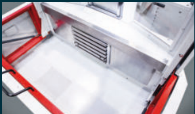
Versenkbarer Arbeitsschutz mit senkrechter Aufspannfläche.
