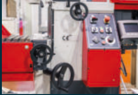
Sicherheitshandräder (X/Y). Ergonomisch angeordnete Handräder garantieren leichte und sichere Handhabung in allen 3 Achsen.
