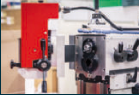
Horizontalfräskopf. Horizontale Frässpindel mit DIN 2080 SK 30 Werkzeugaufnahme. Vertikalfräskopf fix auf Ausschwenkvorrichtung montiert. Vertikalkopfantrieb über Palloidverzahnung.
